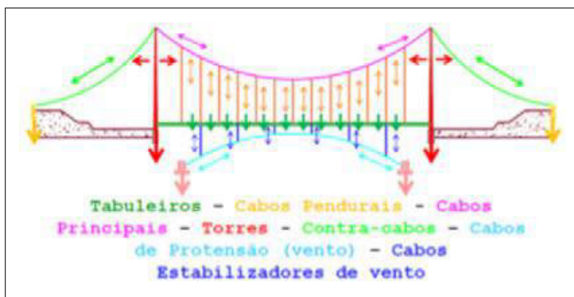
Figura 1. Layout básico de uma ponte pênsil típica
